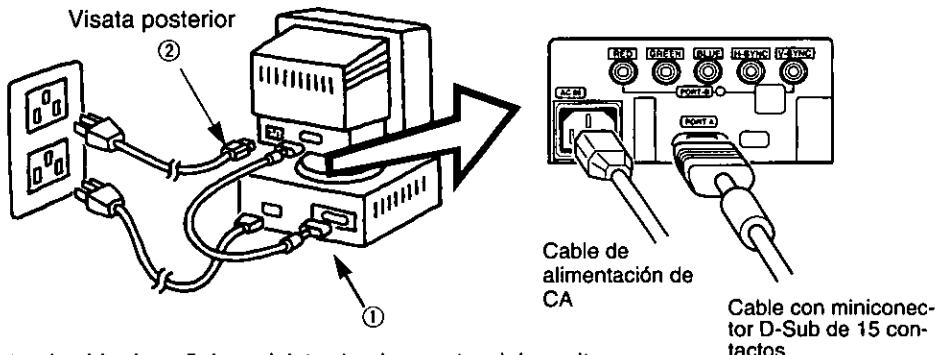
① Conecte el cable de señal suministrado al conector del monitor.
