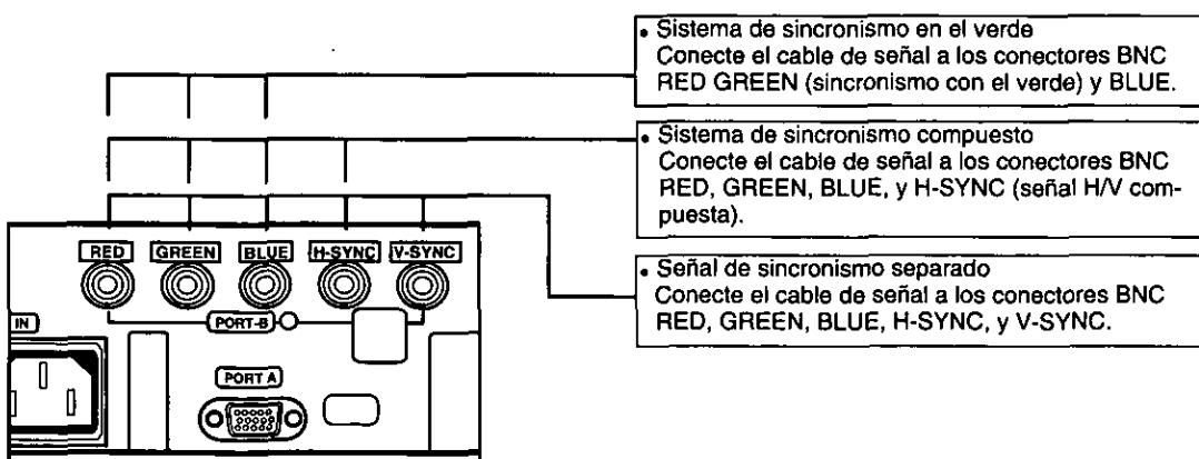
**Nota:** Si la salida de video de su computadora es superior a 110 MHz, le recomendamos utilizar el conector BNC.
