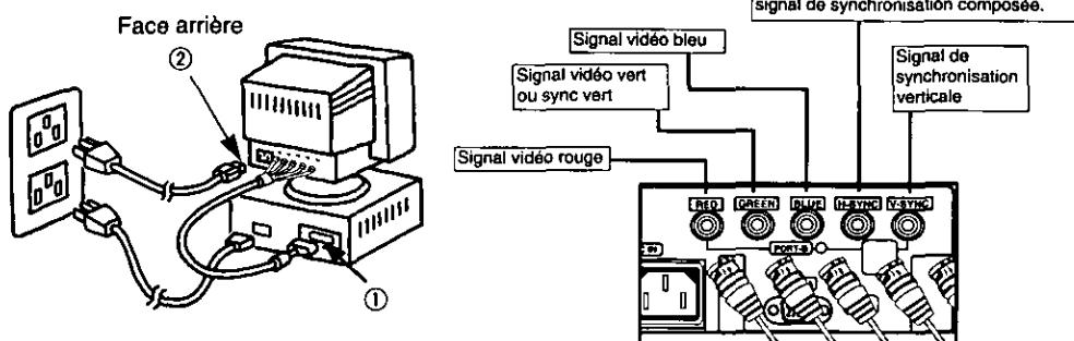
① Raccorder le câble de liaison de signal présent à la prise du moniteur vidéo.
