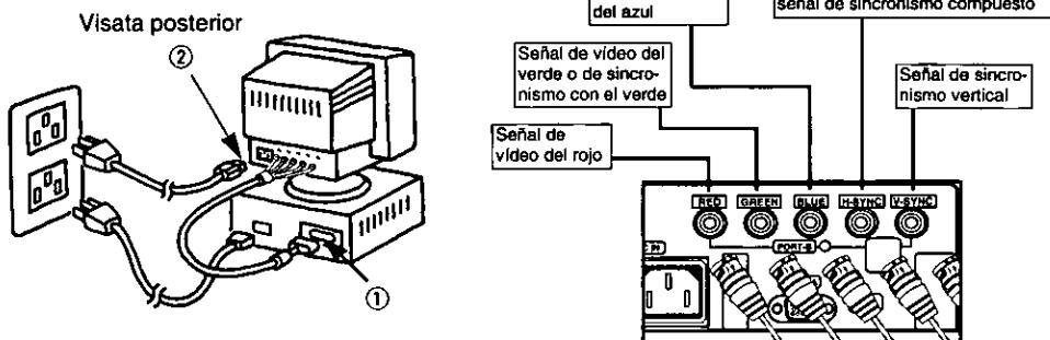
① Conecte un cable de señal con conector BNC (no suministrado) al conector del monitor.
